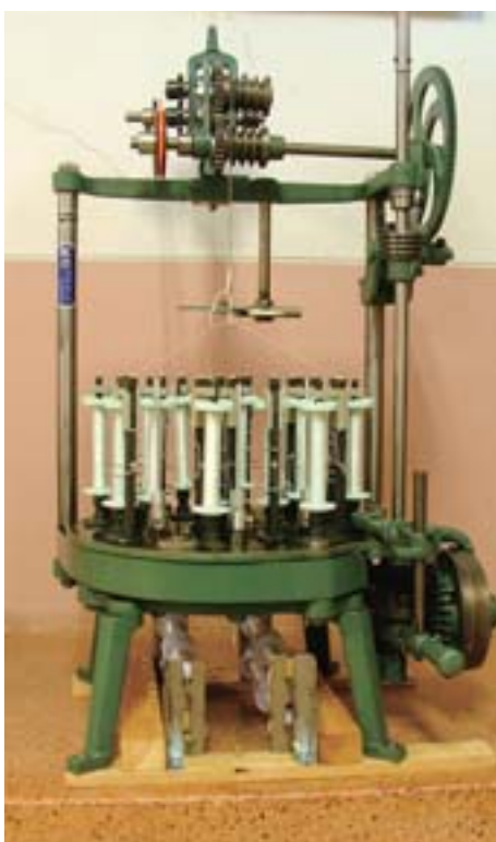
写真右上：ラット腹部大動脈に移植後1年の絹製人工血管断面 写真左上：内径1.5mm人工血管断面の電子顕微鏡写真 写真右下：伝統的な組みひも機「丸台」（東京農工大学科学博物館蔵） 写真左下：人工血管作製に使用している組みひも作製装置（東京農工大学科学博物館蔵）
