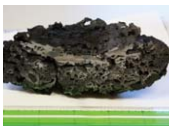
写真上：4基のミニたたら炉による実習風景 写真下：取り出した鉄の塊（約10kgの鉄を半分に切断）
