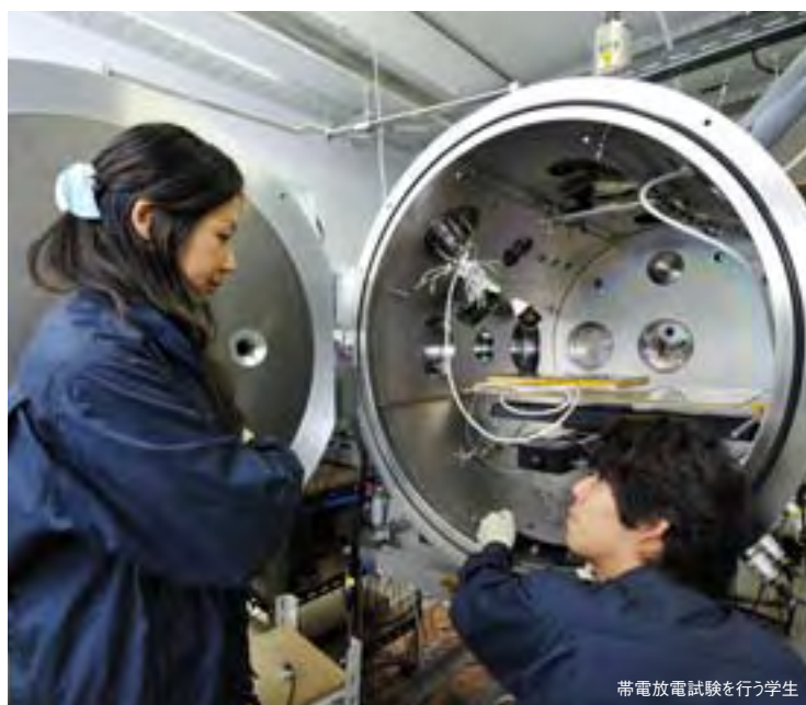
人工衛星の帯電放電試験施設
