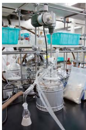
原料であるポリフェノールと酢酸を混ぜ合わせ攪拌する装置。装置の右に見えるのが、ポリフェノールの粉末
