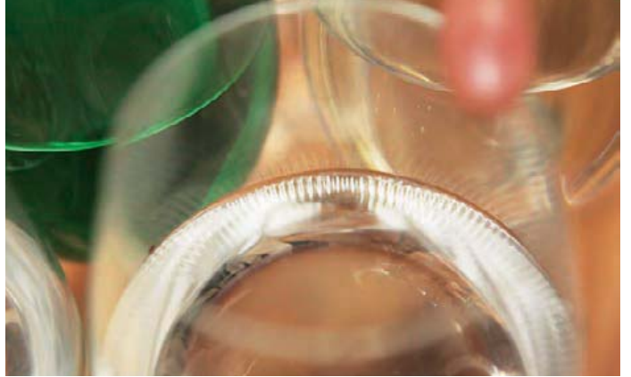
指先を湿らせて、指の腹でワイングラスの縁をこすると、グラスの中の水にさざ波が立ち、美しい音が出る
