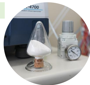
▲DACに使う吸着剤。第4級アンモニウム基をもつ陰イオン交換樹脂を使用している。
