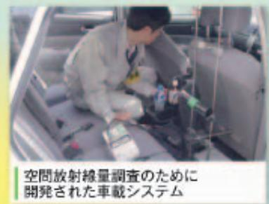
空間放射線量調査のために開発された車載システム
