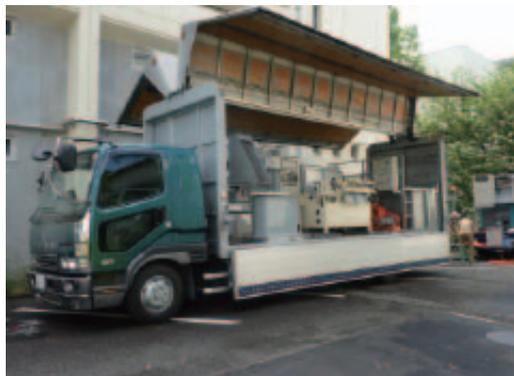
実証実験で有効性を確認した、トラックで運ぶことができるモバイル型汚染水浄化装置 (4tトラック搭載用)
