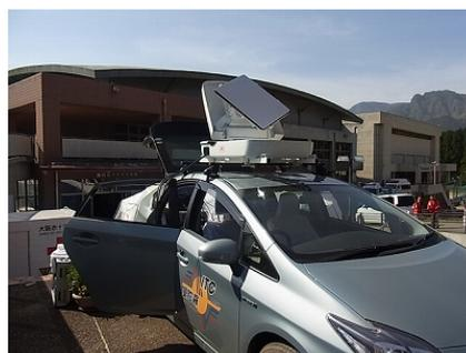
移動式衛星通信システム搭載車両
