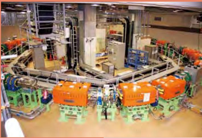
群馬大学が群馬県と共同で建設した重粒子線照射施設内にある、照射治療で使用されるシンクロトロン加速器
