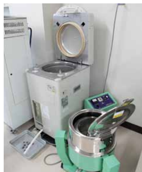
抽出した成分を分離する遠心分離機。様々な実験機は必要に応じて借用できる。
