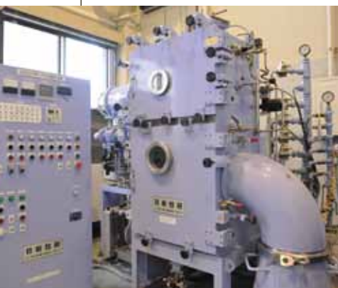
オリジナル金属材料を開発するには、研究に使う機器もオリジナルで作る必要があると河村センター長はいう。金属を溶解して急冷金属を作る「液体急冷薄片作製装置」も教授が設計したもの。
