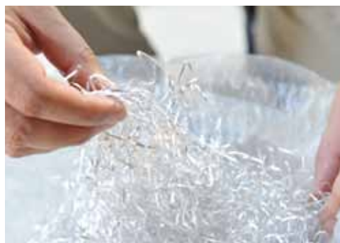
KUMADAI 耐熱マグネシウム合金の急冷薄片。マグネシウムは極めて燃えやすいという難点がある。扱いも難しかったが、難燃となって安心して加工できるようになった。
