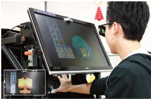
「3D合成ディスプレイとHIRO IIIによるVR触診訓練システム」物体の触感や力を、3次元で5本の指先すべてに伝える世界初のシステム
