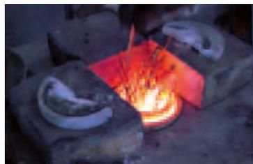
梵鐘の小型試験体を作製するために金属をとくす
