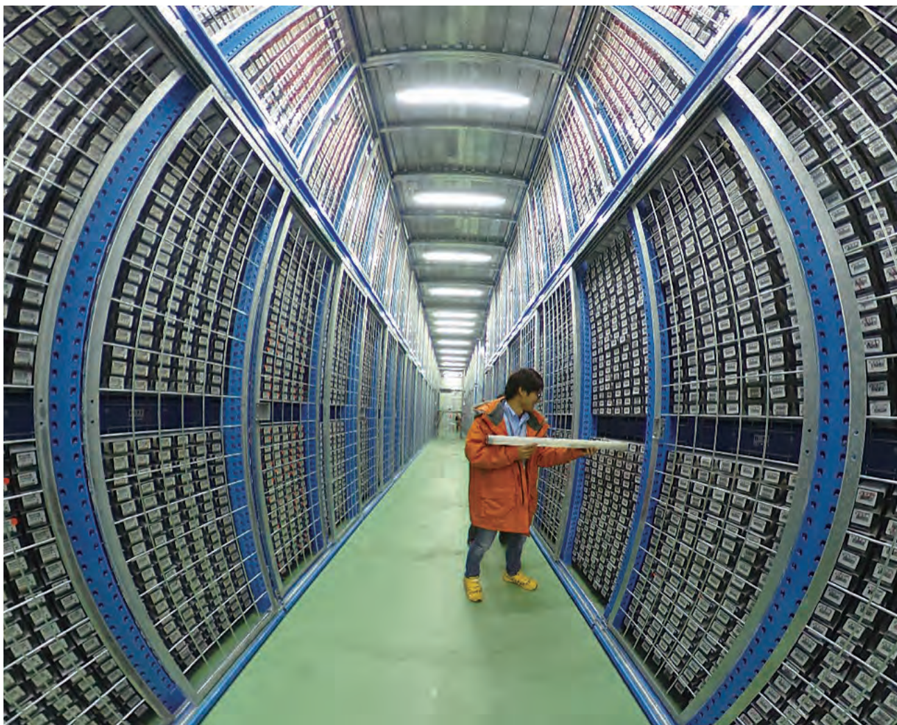
高知大学海洋コア総合研究センターのコア冷蔵保管庫。世界中の海底から掘削された海洋コアが変質しないように4℃程度で保管されている。
